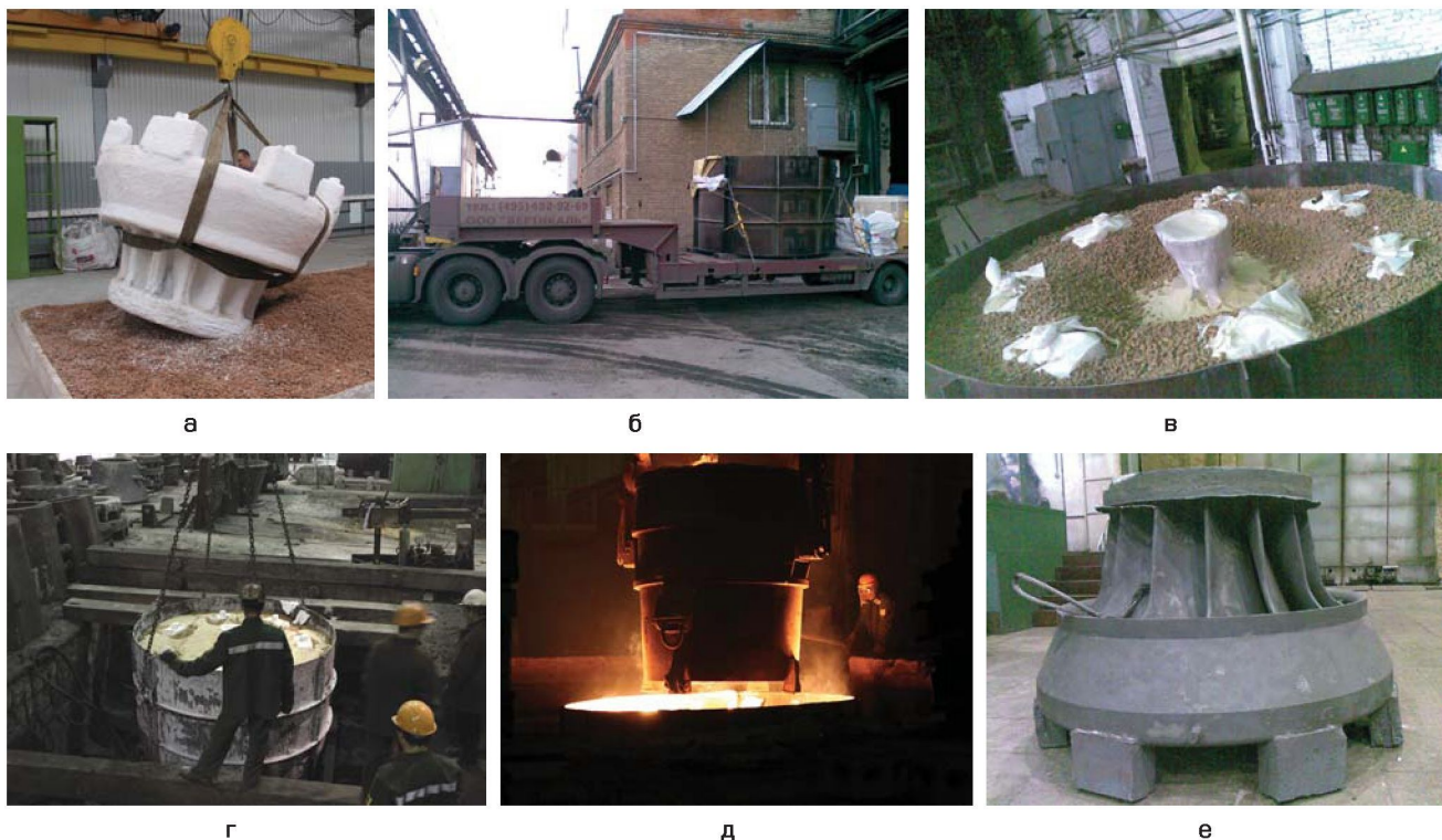
Рис. 7. Рабочие моменты по изготовлению рабочего колеса: а – такелаж керамического блока; б – транспортировка керамического блока на ОАО «ЭЗТМ»; в – подготовка опоки под нагрев; г – установка подогретой формы под заливку; д – заливка формы из стопорного ковша; е – вид отливки после пескоструйной обработки
