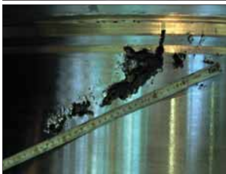
Рис. 3. Загрузочная крышка с усадочными дефектами
