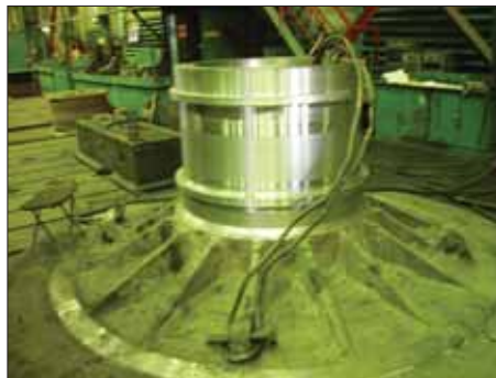
Рис. 6. Загрузочная крышка, изготовленная с применением измененной технологии
