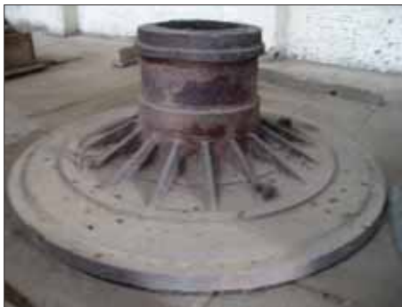
Рис. 6. Загрузочная крышка, изготовленная с применением измененной технологии
