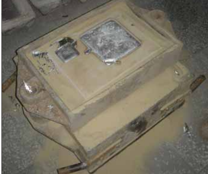
Рис. 13. Произведена заливка алюминиевого сплава
