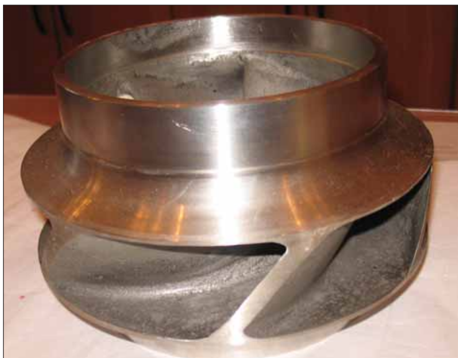
Рис. 9. Удалены прибыли и литники. Обработаны посадочные поверхности
