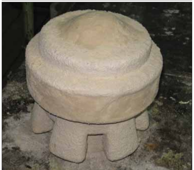
Рис. 4-5. Окончательный вид корки перед выжиганием модели
