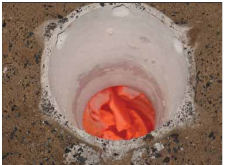
Рис. 6. Корка в опоке непосредственно после выжигания. Следующий этап – продувка
