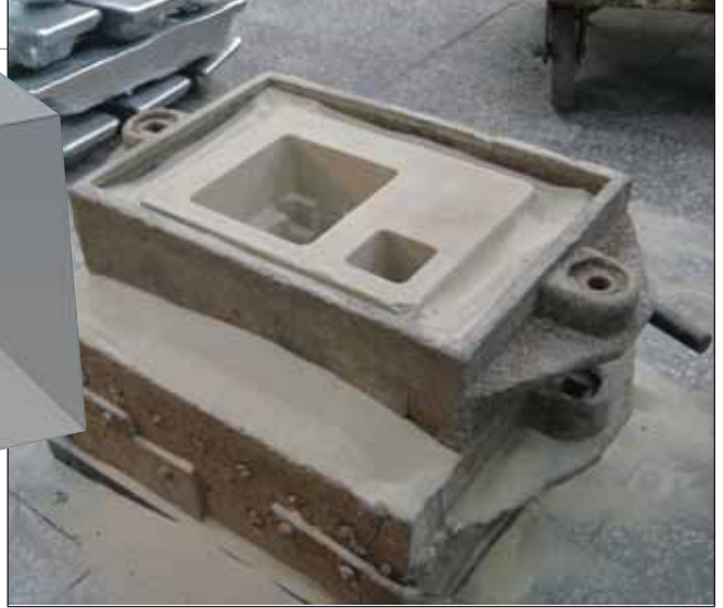
Рис. 12. Для безопасности модель помещена в металлическую опоку и засыпана песком
