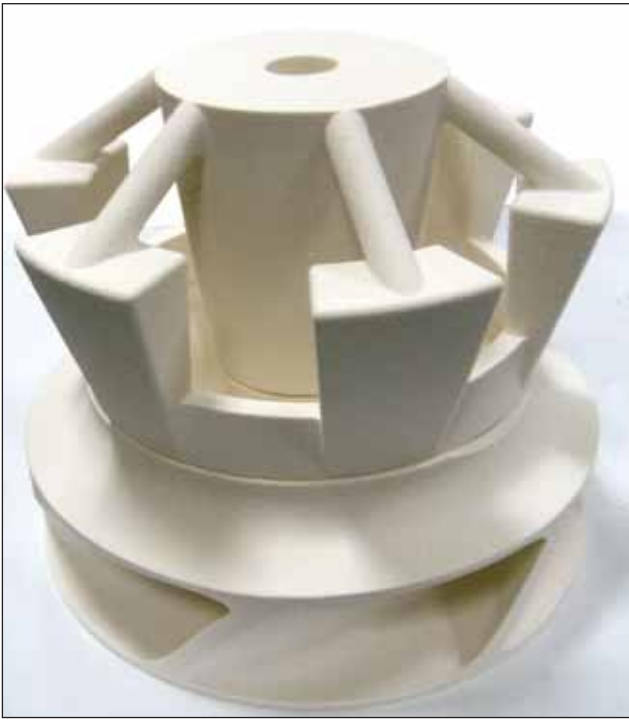
Рис. 3. После выращивания две части модели соединяются клеевым составом
