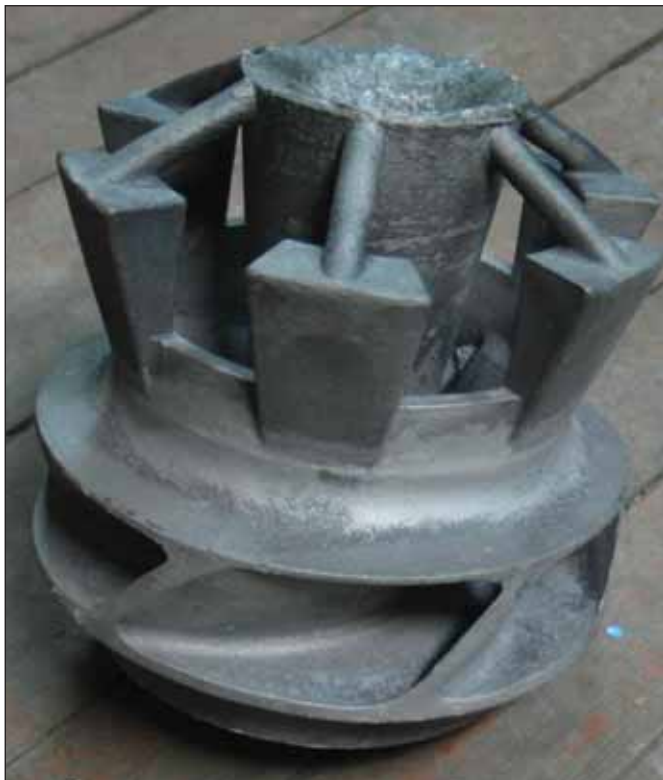
Рис. 7. Отливка. Правильно рассчитанная схема размещения прибылей и литников позволила избежать дефектов литья
