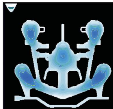
Рис. 14. Цветовая индикация времени кристаллизации в разных областях отливки
