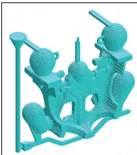
▲ Рис. 7. Отливка с литниково-питательной системой
