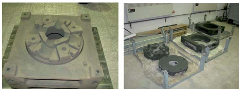
Рис. 9. Готовый стержень, полученный на установке селективного отверждения
